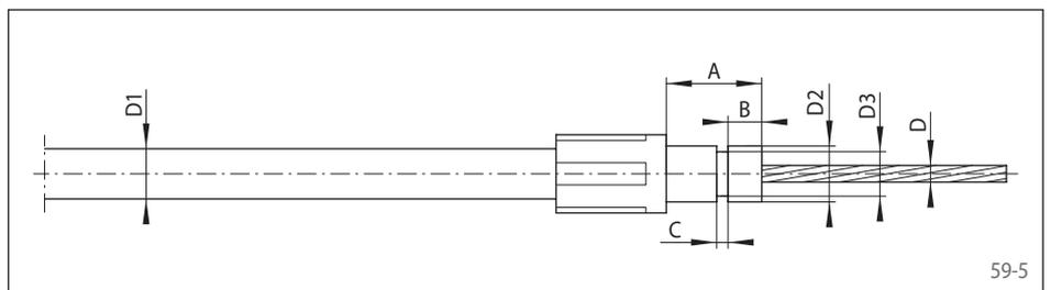
**Ansatzhülse für Sicherungsclip mit Dichtung**
