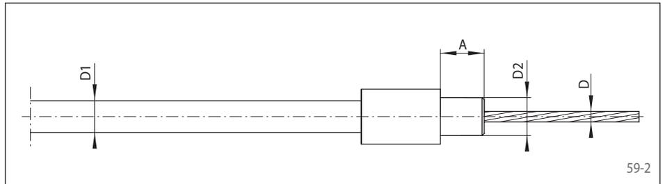
**Klemmbefestigung mit Front End Insert**
