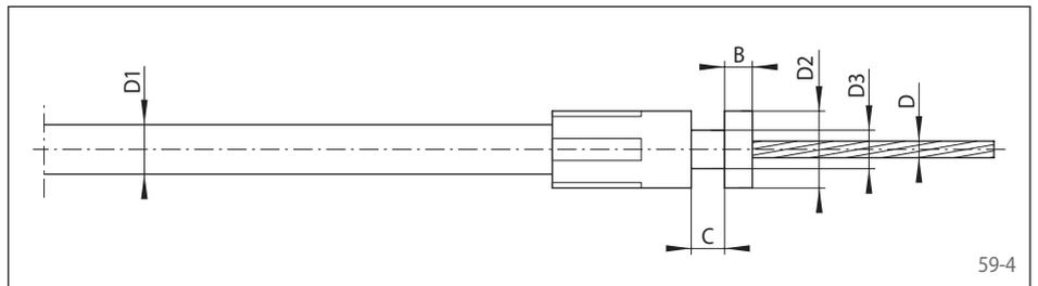
**Ansatzhülse für Sicherungsclip**
